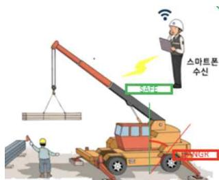
○ (지원목적) 이동식 크레인에 “이동식 크레인 스마트 통합전도방지 시스템”을 설치하여 전도·떨어짐 등에 의한 사고사망 감축에 기여
